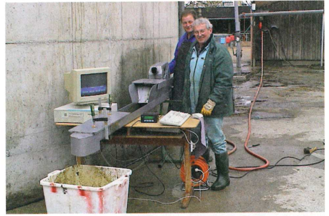
Am Spitalhof in Eigenbau entwickelte Lösungen: Exakte Gülleausbringung auf Versuchspartellen und reproduzierbare Messung der Fließfähigkeit von Gülle.
