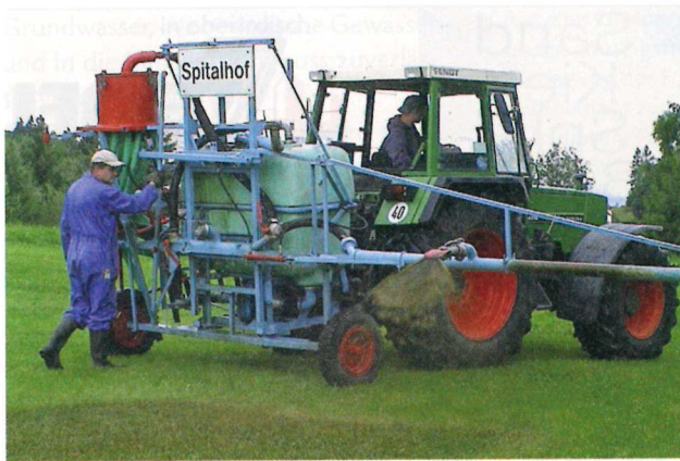
Am Spitalhof in Eigenbau entwickelte Lösungen: Exakte Gülleausbringung auf Versuchspartellen und reproduzierbare Messung der Fließfähigkeit von Gülle.
