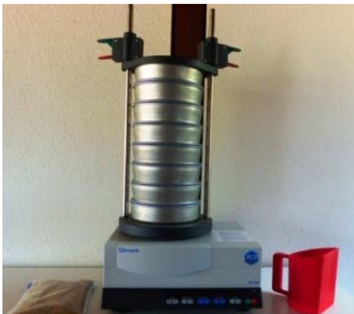
Abb. 17: Siebanalysegerät zur Bestimmung der Futterstruktur
