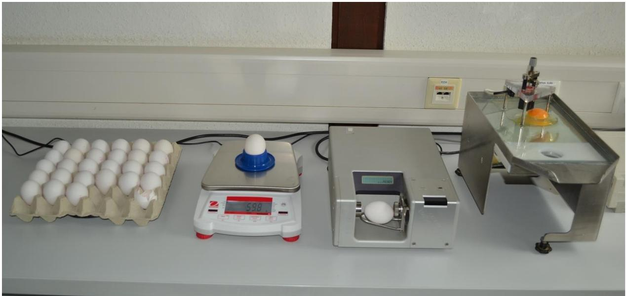
Abbildung 5: Messstrecke zur Erfassung der Eiqualitätsparemeter Eigewicht, Bruchfestigkeit, Eiklarhöhe
